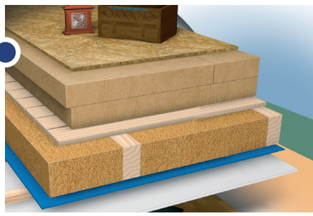
Isolering af etagedæk under uisolerede lofter med TFDK mellemisoleringsplade.
